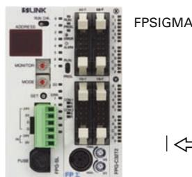
La connessione a "T" di S-LINK riduce i cablaggi e permette una semplice installazione.
