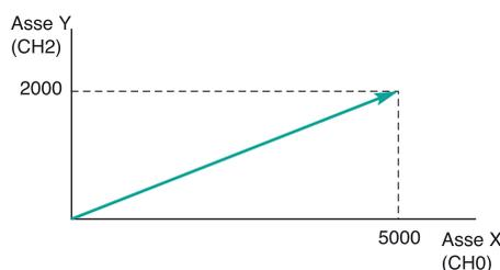
La funzione di controllo definisce automaticamente un continuo di posizionamenti in sequenza su una linea retta, basata sulle posizioni identificate da 2 coordinate.
