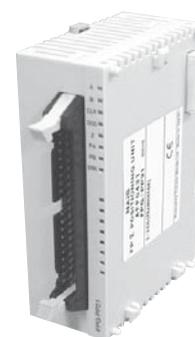
Controllo di posizionamento con un motore passo passo
