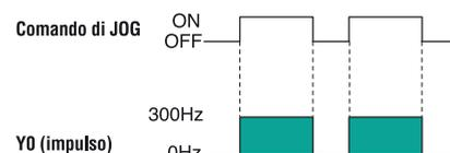
Si riferisce ad un'operazione nella quale il motore viene azionato solamente mentre un comando operativo è attivo. Questo viene utilizzato per forzare l'attivazione del motore tramite comandi esterni al Plc, come nel caso di regolazioni manuali. In alcuni casi, a seconda delle circostanze, si può dare all'operazione JOG un'abilitazione illimitata, in modo tale da avere il motore in rotazione continua.
