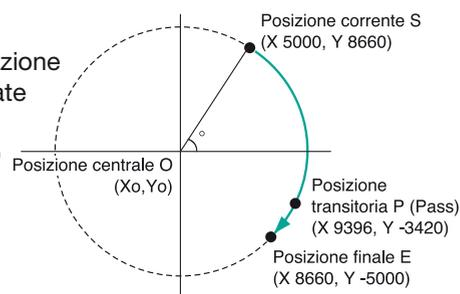
Permette di attraversare con regolarità i punti tramite traiettorie ad arco che gli utenti possono specificare, per ottenere così raggi di curvatura, profili e direzione del movimento richiesti.
